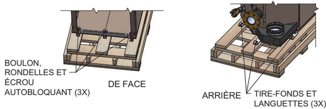
**Figure 1-3** Chaudière retirée de la palette d'expédition
