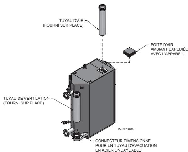
La Crest utilise une prise d'air de combustion et des tailles de tuyauterie de ventilation spécifiques du modèle et détaillées aux Tableaux 2B et 2C de la page 18.
