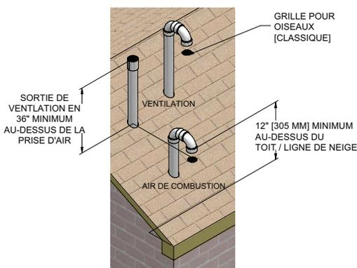
Figure 3-2 Terminaison verticale de l'air et de ventilation avec pluie Bouchon
