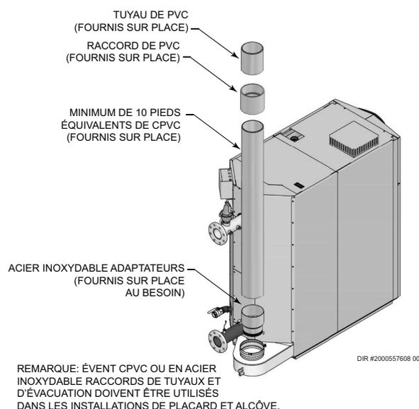
5. Sécher le tuyau de ventilation ou d'air pour permettre un bon raccordement avant de coller l'ensemble. Le tuyau doit rentrer de un à deux tiers dans le raccord pour permettre une bonne étanchéité après avoir mis la colle.
