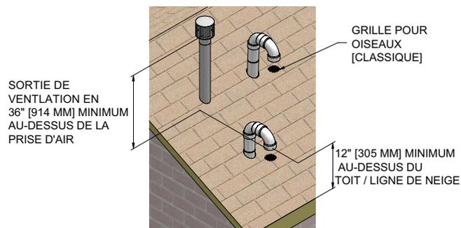
5. Situer les terminaisons de façon qu'elles ne puissent pas être endommagées par des objets étrangers, comme des pierres ou des balles, ou susceptibles d'accumuler des feuilles ou des sédiments.
